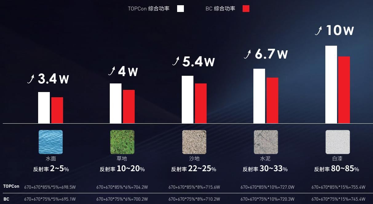
BC电池由于背面结构复杂且电极区域全部在背面，因此背面光吸收的优化难度更大；尽管BC也在提升双面率，但由于背面结构的限制，实现高双面率仍然具有很大的挑战。BC电池因背面电极遮挡，导致其天然在双面率上存在弱势。以及由于制作工艺的复杂，导致BC电池的厚度增加，从而导致BC电池缺陷增多，以及造成背面吸光性能弱于TOPCon。
